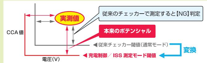
「充電制御/アイドリングストップ車測定モード」とは、バッテリーメーカーの蓄積されたノウハウから導き出した、高回生バッテリー専用の閾値で測定、バッテリー本来の性能を正しく判定することを可能にしました。
