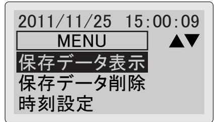
②右記の保存データ一覧画面が表示されます。表示したいファイルを $\Delta/\nabla$ (上・下スクロール)キーで選択し $\blacktriangleleft$ (決定)キーを押してください
