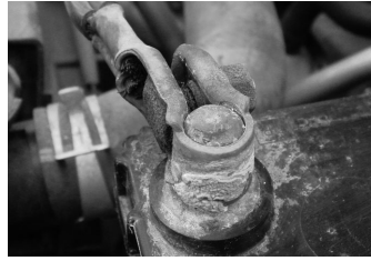
腐食したターミナル
