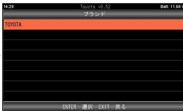
④トヨタメインメニューが表示されたら「作業サポート」を選択して ENTER キーを押してください。そのあとに表示される作業サポートで「作業サポート[New]」を選択して ENTER キーを押してください。
