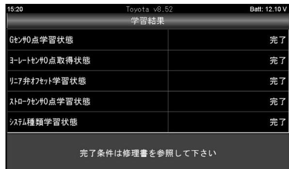
※スリップインジケータが 0.25 秒周期の点滅をせず、「学習結果」で「リア弁オフセット学習」の項目が「未完了」と表示される場合は、一度車両側 POWER スイッチを OFF にして 4 分間以上待機したあと、再度、4 ページの手順 04、5 ページの手順 05 を行ってください。
