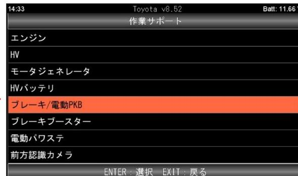
⑥「システム確認中しばらくお待ちください」が表示されたあと「ブレーキ/電動 PKB」の作業サポート選択の画面が表示されます。
