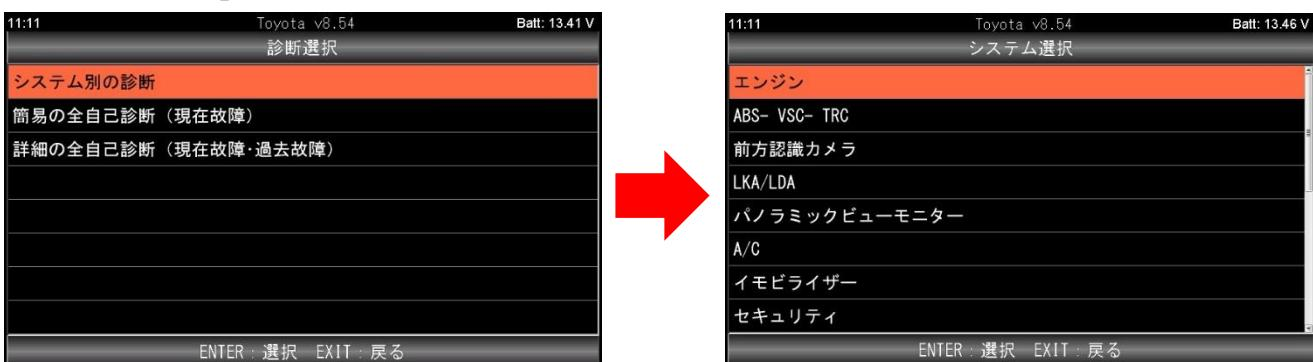
③「エンジン」が表示されたら「データモニター」を選択して ENTER キーを押してください。「イニシャライズ中…しばらくお待ちください。」が表示されたあと、「表示項目選択」が表示されます。
