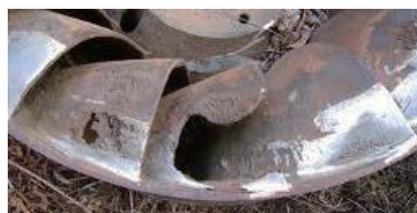
Propulsor marino erosionado por cavitación
